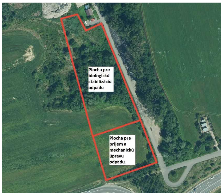
Obr. 13 Dispozícia navrhovanej stavby
